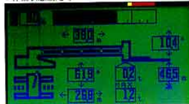
●ACSジブ作業時
