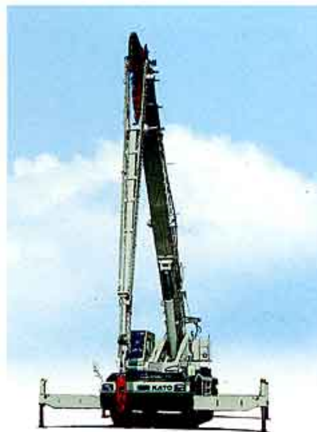
●狭い現場で短時間でセット、油圧式サイドアップジブ
