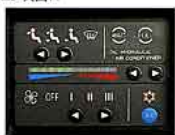
●エアコンパネル
