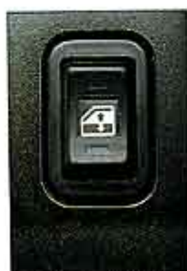
●ワンタッチで操作できる パワーウィンドウスイッチ
